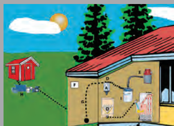
KIT 1: Σύστημα μεταφοράς pellets από εποχιακή δεξαμενή στο σιλό του λέβητοστασίου
