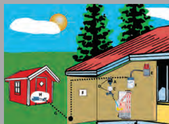
KIT 3: Σύστημα μεταφοράς pellets από εποχιακή δεξαμενή απευθείας στον καυστήρα.
