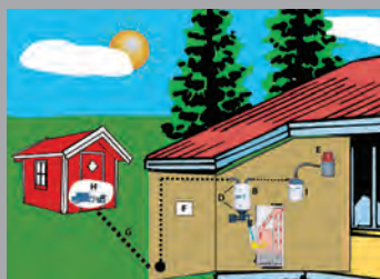
KIT 2: Σύστημα μεταφοράς pellets από εποχιακή δεξαμενή απευθείας στον καυστήρα. (Δεν λειτουργεί με όλους τους τύπους καυστήρων!)
